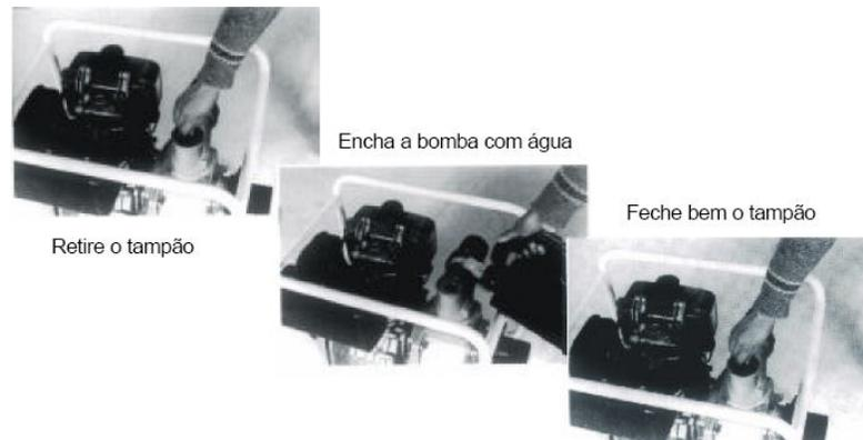
Antes de ligar o equipamento complete o corpo da bomba com água limpa. Jamais ligue o motor sem antes completar o corpo da bomba com água. Com as tubulações de sucção e recalque já instaladas, desatarraxe o bujão na parte superior da bomba e encha completamente com água limpa. Reinstale o bujão na bomba.
