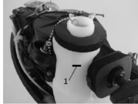
Tanque de Combustible Interno (1 – Limite Superior)
