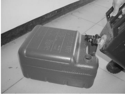
Tanque de Combustível Externo
