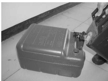
Tanque de Combustível Externo
